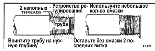
РИС. 5 – ИСПОЛЬЗУЙТЕ УМЕРЕННОЕ КОЛИЧЕСТВО КОМПАУНДА ДЛЯ ТРУБ.
