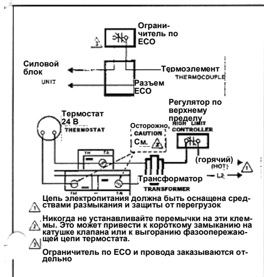
РИС. 9 ТИПОВАЯ СХЕМА ПОДКЛЮЧЕНИЯ ДЛЯ СИСТЕМ 24 В
